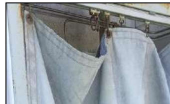
ハトメ部分が破れてランナーから外れている
